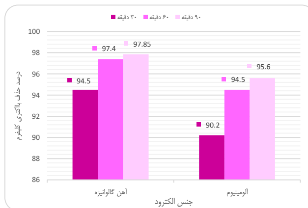
نمودار ۱- مقایسه حذف باکتری‌های کلی فرم توسط الکترودهای آهن گالوانیزه و آلومینیوم در زمان‌های متفاوت (اختلاف پتانسیل ۲۰ ولت)
